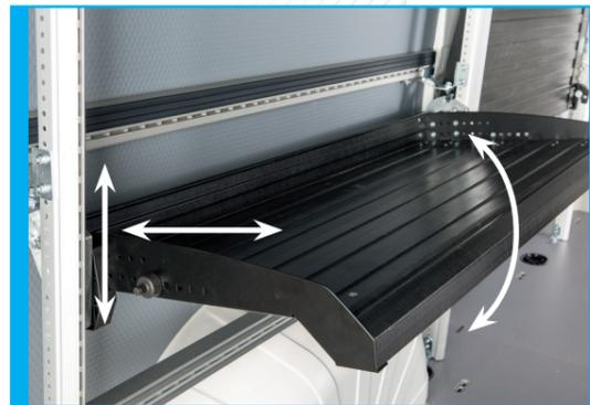
**Fachboden zur Fahrzeugwand, in der Höhe und im Neigungswinkel verstellbar**
